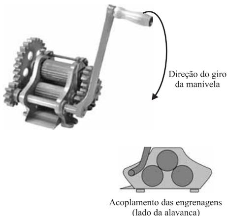
Ao produzir caldo de cana, uma pessoa gira a manivela fazendo-a completar uma volta a cada meio minuto. Supondo que a vara de cana colocada entre os cilindros seja esmagada sem escorregamento, a velocidade escalar com que a máquina puxa a cana para seu interior, em cm/s, é, aproximadamente,
