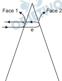
Ocorrem duas reflexões, uma com inversão de fase na face externa 1 e outra sem inversão de fase na face interna 2, e, em seguida, pode ocorrer interferência entre os raios refletidos.
