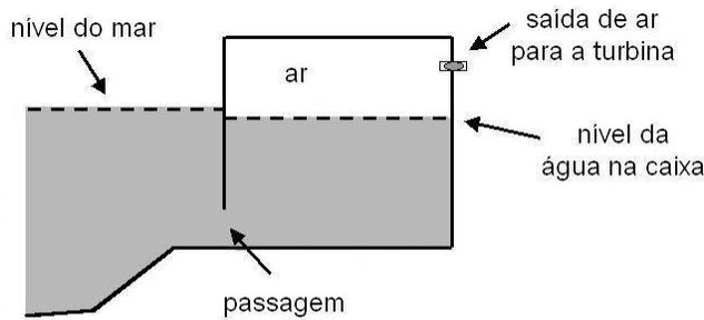
**a)** Inicialmente, o nível da água está a 10 m do teto e a pressão do ar na caixa é igual à pressão atmosférica ( $10^5 \text{ Pa}$ ). Com a saída para a turbina fechada, qual será a pressão final do ar se o nível da água subir 2,0 m? Considere que no processo a temperatura do ar permanece constante.
