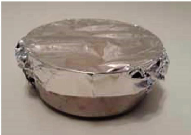
Passados alguns dias, surgiram pequenos furos na folha de alumínio, como resultado da corrosão, que ocorreu devido ao fato de o molho de tomate ser uma solução eletrolítica e de dois metais diferentes terem sido colocados em contato, formando, assim, uma pilha.
