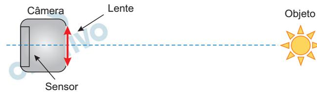
Em uma câmera digital que utilize uma lente convergente com 20 mm de distância focal, a distância, em mm, entre a lente e o sensor da câmera, quando um objeto a 2 m estiver corretamente focalizado, é, aproximadamente,
