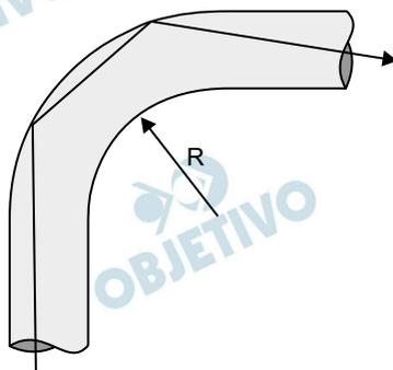
Para que haja reflexão total de um feixe de luz inicialmente paralelo ao eixo do tubo, o menor raio de curvatura interno  $R$  (ver figura) deve ser igual a
